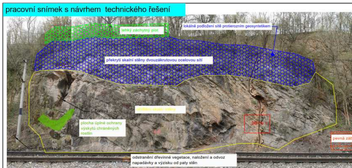
Obr. 13: Návrh technického řešení sanace lokality č. 9. (žlutě ohraničeno – očištění skalní stěny od veškeré vegetace, zvětralin a horninových úlomků, modrá síť – překrytí skalní stěny ocelovou sítí, zelené plochy – úplná ochrana výskytu ZCHD rostlin, zelená síť – lehký záchytný plot)
