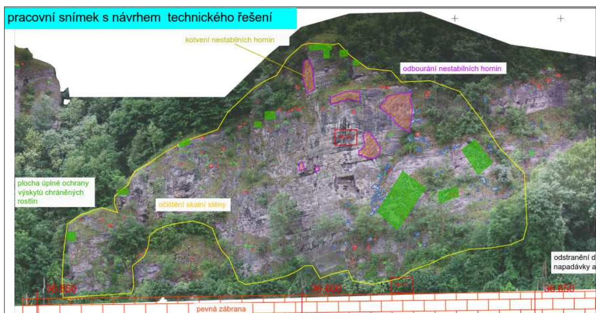
Obr. 26: Návrh technického řešení sanace lokality č. 18 (žlutě ohraničeno – očištění skalní stěny od veškeré vegetace, zvětralin a horninových úlomků, zelené plochy – úplná ochrana výskytu ZCHD rostlin, fialově – odbourání nestabilních bloků, červeně – pevná zábrana)
