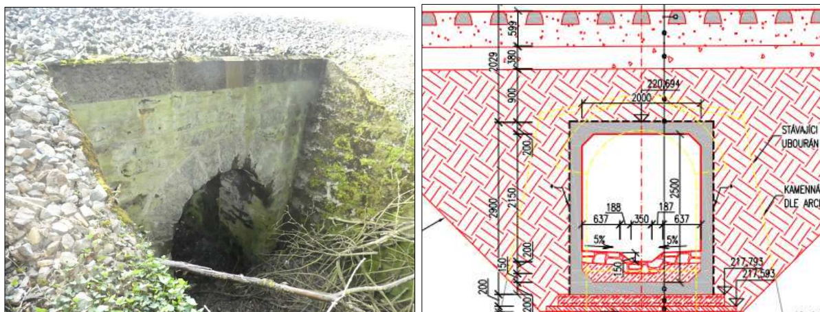
Obr. 52: Mostní objekt v km 36,734, vpravo nový stav
