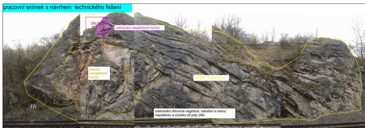
Obr. 14: Návrh technického řešení sanace lokality č. 9a (žlutě ohraničeno – očištění skalní stěny od veškeré vegetace, zvětralin a horninových úlomků, růžová šrafa – odbourání nestabilních hornin)
