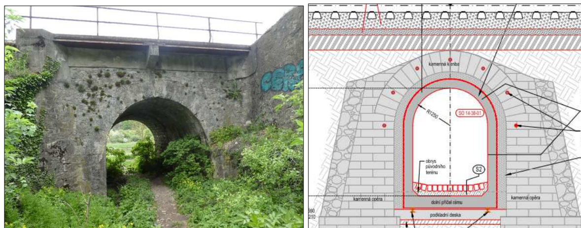
Obr. 37: Mostní objekt v km 36,114, vpravo navržené řešení
