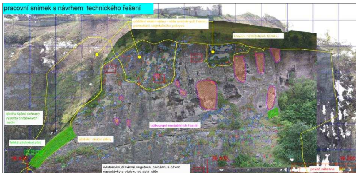
Obr. 25: Návrh technického řešení sanace lokality č. 17 (žlutě ohraničeno – očištění skalní stěny od veškeré vegetace, zvětralin a horninových úlomků, resp. s podmínkou, zelené plochy – úplná ochrana výskytu ZCHD rostlin, fialově – odbourání nestabilních bloků)
